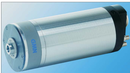
Rys. 1. Elektrowrzeciono HSX 100 60 000/5 z manualną wymianą narzędzia. Dane: średnica zabudowy 100 mm, maks. prędkość 60 000 obr/min, moc 5 kW, chwyt cylindryczny
