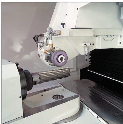
Rys. 2. Wrzeciennik z bezpośrednim napędem, sonda do pozycjonowania i pomiaru narzędzia
