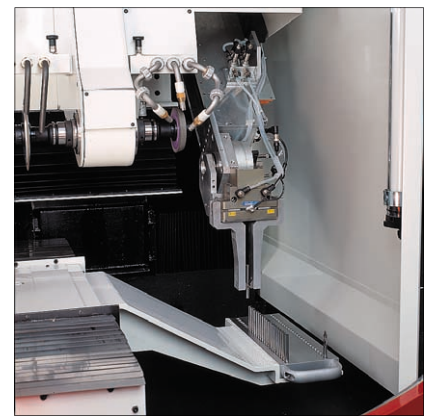
Rys. 3. Zintegrowany system podawania narzędzi umożliwia zautomatyzowanie procesu szlifowania
