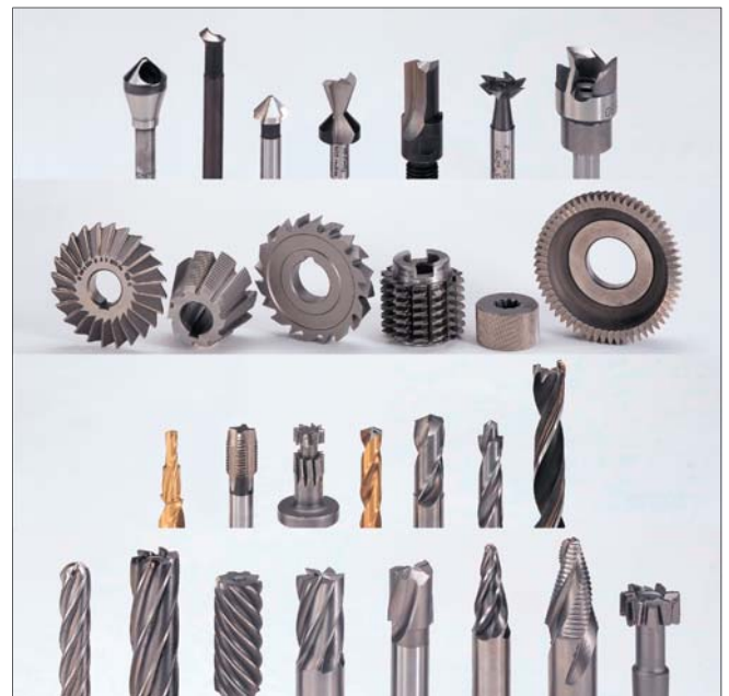
Rys. 3. Spektrum narzędzi ostrzonych na szlifierce UWIC
