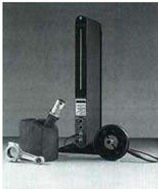
Rys. 3. Zastosowanie dwóch przyrządów pomiarowych do jednej kolumny 2-kanalowej; dzięki funkcji Autoswitch możliwa naprzemienną pracą kolumny
