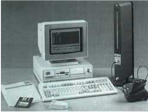
Rys. 5. Możliwość zdalnego programowania kolumny za pomocą komputera PC oraz gromadzenia i obróbki danych uzyskanych z czujnika indukcyjnego przyrządu QUICK-SNAP
