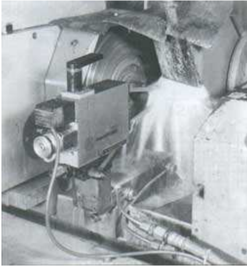
Rys.1. Kontrola średnicy zewnętrznej w trakcie procesu szlifowania
