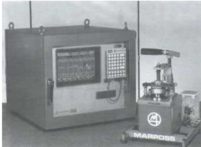
Rys.2. Stanowisko do kontroli piasty po procesie obróbki wraz z urządzeniem do analizy statystycznej
